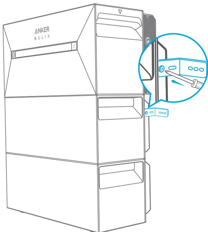
5. Markieren Sie die Position der Bohrlöcher auf beiden Seiten und verwenden Sie eine Bohrmaschine mit einem  $\phi 8$ -Bohrer und einer Tiefe von 60 mm.
