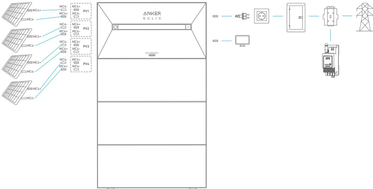
1. Schließen Sie die Solarbank mit dem mitgelieferten Netzkabel mit Schukostecker (5 m) an eine Steckdose zu Hause an.
