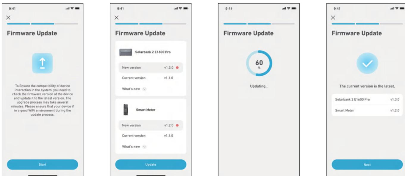
1. Wenn es ein wichtiges Update für die Firmware der Solarbank oder des Smart Meters gibt, wird die App Sie durch den Prozess führen. Vergewissern Sie sich, dass Ihre Geräte eingeschaltet und mit WLAN verbunden sind, bevor Sie die Aktualisierung durchführen.
