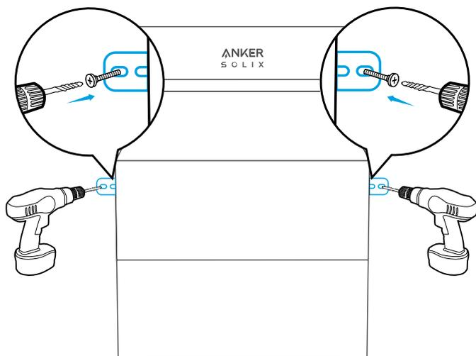
6. Klopfen Sie mit einem Hammer die Kunststoffhülse der selbstschneidenden Schraube M5×60 in das Loch, und verwenden Sie dann einen Kreuzschlitzschraubendreher, um die selbstschneidende Schraube M5×60 am L-förmigen Wandmontagebeschlag zu befestigen.
