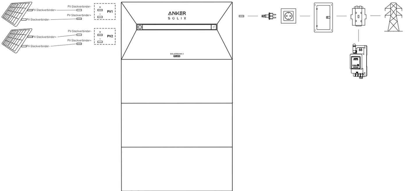
1. Schließen Sie die Solarbank mit dem mitgelieferten Netzkabel mit Schukostecker (5 m) an eine Steckdose zu Hause an.
